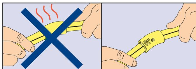
4. Não submeta as termofusões realizadas a tensões desnecessárias (giros, movimentos, deslocamentos, esforços) durante a etapa de resfriamento.
