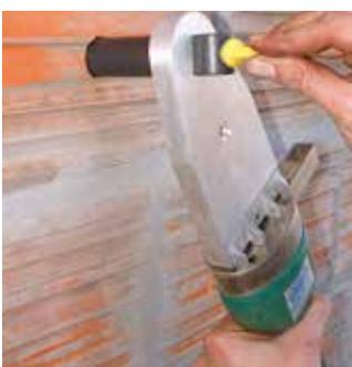
5. A seguir, aqueça a sela de reparação durante 15 segundos, sem retirar o bocal do tubo. Somando os tempos de aquecimento (10 s + 15 s), o aquecimento total do tubo atinge 25 segundos.
