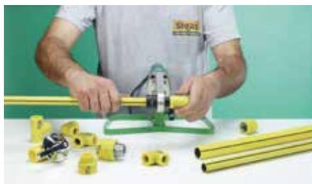
2. Aquecimento do tubo e da conexão a 260°C
