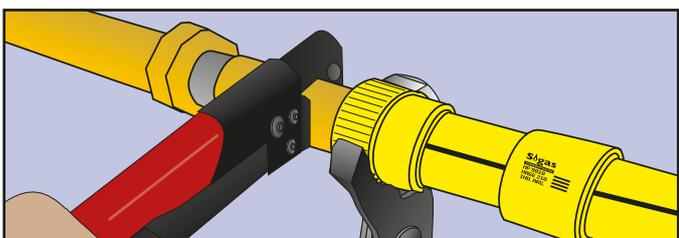
3. Ao unir duas peças rosqueadas, utilize duas chaves de grifo. Com uma se enrosca e com a outra se segura a peça vinculada com extremidades rosca-fusão, para evitar o rompimento da união fusionada.
