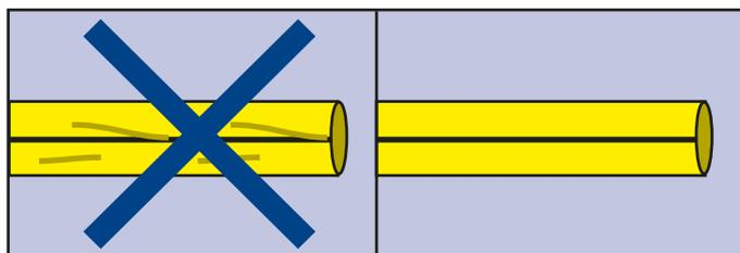
1. Se os tubos e/ou conexões evidenciarem uma deterioração marcada que inviabilize sua instalação, deverão ser descartados.
