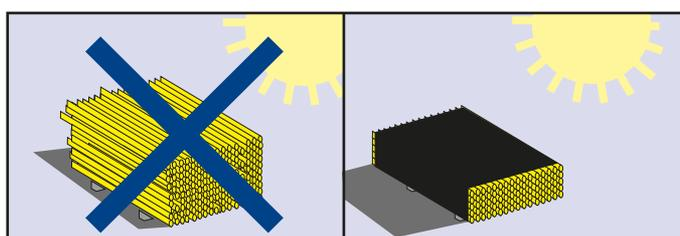
5. Os tubos em obra poderão ficar, por algum tempo, empilhados à intempérie, protegidos com uma lona de polietileno preto, de modo a formar uma câmara de ar entre a lona e os tubos.
