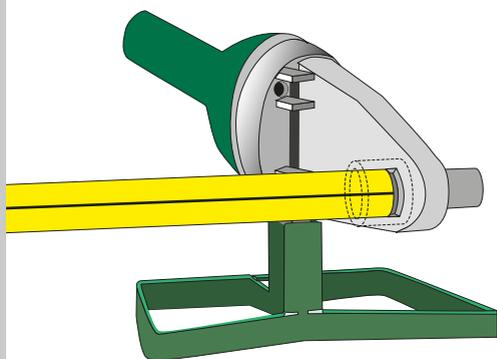
A fusão se realiza por contato direto das superfícies a serem unidas, que devem encontrar-se em estado plastificado. Ao terminar o processo de fusão molecular pode-se observar, na união, um cordão visível formado pelo próprio movimento do material plastificado. A temperatura nos bocais pode oscilar entre 245° e 275°. A temperatura de equilíbrio é 260°.
