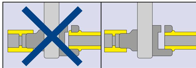
6. Na Termofusão de tubos de 20 e 25 mm não ultrapassar a borda exterior da janela do bocal. Em diâmetros de 32 mm em diante deve-se respeitar a profundidade de inserção dos tubos indicadas na tabela 2 da página 12. Não pretender verificar o diâmetro externo dos tubos usando como medidor os próprios bocais frios.
