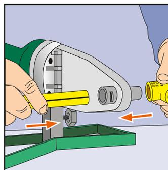
6. Introduzir simultaneamente o tubo e a conexão nos bocais, de forma perpendicular à placa.
