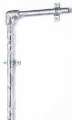
5. Os pontos onde a tubulação se encontra fixada mediante suportes metálicos deverão levar duas voltas adicionais da fita para promover uma maior resistência mecânica à proteção. Essas voltas adicionais devem ser feitas de forma perpendicular ao eixo da tubulação.
