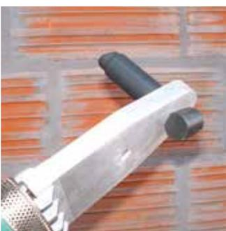
3. Instale os bocais especiais para sela de reparação no termofusor. O bocal côncavo é para aquecer o tubo e o bocal convexo, para aquecer a sela de reparação.
