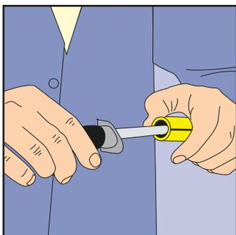
4. O tubo de aço deve ser refilado com lima redonda, para eliminar rebarbas.
