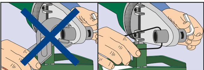
5. Para trocar os bocais frios ou quentes utilize as pinças para extração de bocais fornecidas com o sistema SIGAS Termofusão®, evitando assim rachaduras e desgaste prematuro.
