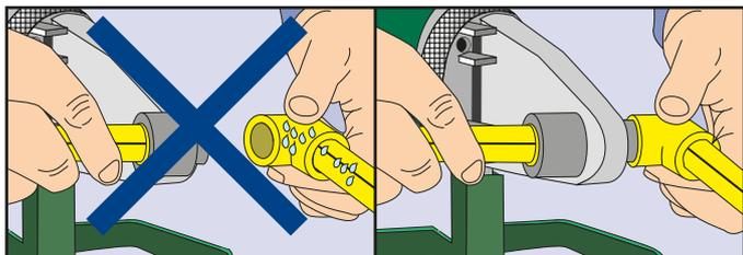
1. Certifique-se de que todas as superfícies a unir estejam secas. Não termofusione se houver umidade na superfície.
