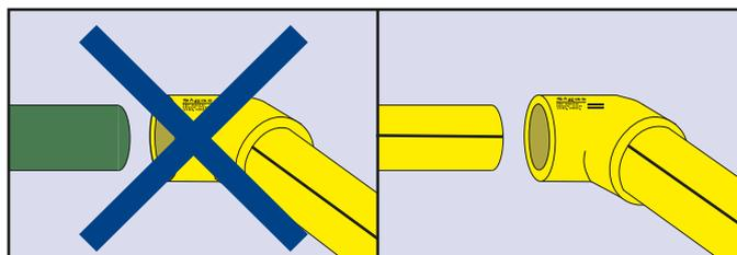
2. NÃO TERMOFUSIONAR SIGAS Termofusão com outra tubulação que não seja SIGAS. Usar somente bocais e termofusores fornecidos pelo GRUPO DEMA, para assegurar temperaturas, medidas e tolerâncias de acordo com o sistema SIGAS Termofusão®.
