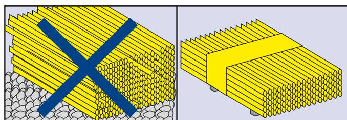
6. O empilhamento dos tubos deverá ser realizado sempre sobre superfícies planas e limpas. Quando o piso for irregular ou abrasivo, o empilhamento deverá ser feito sobre tablados de madeira ou vigas de material adequado.
