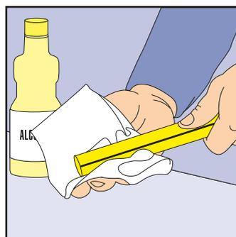
5. Limpar a ponta do tubo e o interior da conexão com um papel absorvente umedecido em álcool comum.
