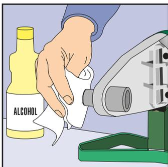
1. Limpar os bocais do termofusor aquecido com um papel absorvente e álcool comum e verificar seu correto ajuste à placa.
