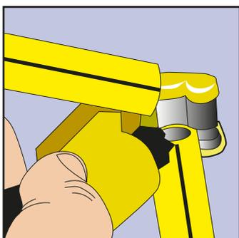
2. Cortar o tubo de forma perpendicular ao eixo, com corta-tubos.
