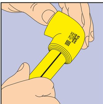
10. Deter a introdução do tubo quando os dois anéis que se formam com o movimento do polietileno se juntarem. Deixar repousar cada Termofusão® até esfriar totalmente (ver tabela I da pág. 12).
