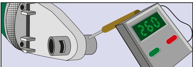
7. Manter sempre o termofusor em ótimas condições de uso e verificar regularmente as temperaturas de trabalho dos bocais com termômetros de contato (pirômetro).
