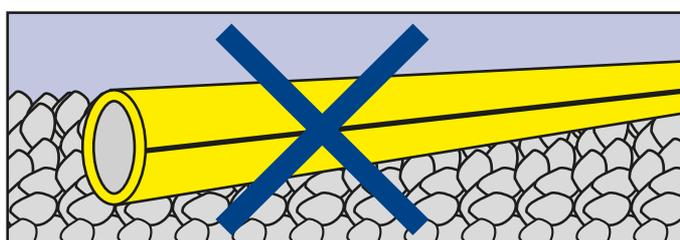
3. As tubulações não deverão ser colocadas ou arrastadas sobre superfícies abrasivas ou com bordas cortantes.
