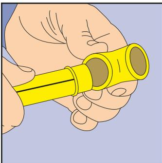
9. Imediatamente depois de tirá-los do termofusor, deve-se introduzir rapidamente o tubo na conexão.
