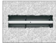
**a)** Para resolver os problemas que ocorrem em pontos localizados nos tubos em instalações já concluídas, em consequência de pequenos acidentes (furos por pregos ou furadeiras), ou vazamentos em juntas mal executadas, a TIGRE oferece aos seus consumidores a Luva de Correr TIGRE;
