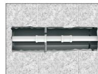
**c)** A solução de problema com Luvas de Correr dispensa o uso de adesivo e roscas, pois as luvas possuem anéis de borracha para vedação. O trecho danificado deve ser substituído segmento do mesmo tipo de tubo. Use duas Luvas de Correr, uma em cada extremidade;
