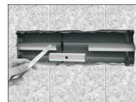
**b)** A Luva de Correr TIGRE tem pequena dimensão e um sistema de acoplamento que permite a interligação entre dois pontos fixos. A parede deverá ser aberta somente num pequeno trecho, junto ao ponto afetado;
