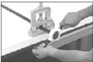
**c)** Empregar sempre Tarraxas TIGRE, os cossinetes usados para tubos de aço não devem ser utilizados nos tubos Tigre. Encaixar o tubo na tarraxa pelo lado da guia, girando 1 volta para a direita e 1/4 de volta para a esquerda, repetindo a operação até obter a rosca no comprimento desejado;
