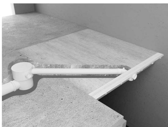
3B - Com desconector embutido na laje.
